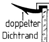
**Abbildung 3 doppelter Dichtrand**
